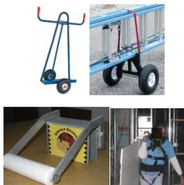
Sistemas ayudas mecánicas para auxiliar manipulación manual de carga (Desplazamientos)
