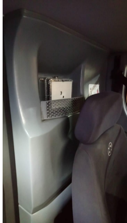
Figura 11: a) Cabina de conducción. b) Compartimento para los sensores de contexto.
